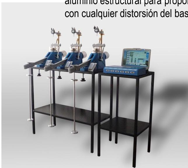
El grupo del puente de carga se apoya con alta precisión en un balero axial, el brazo de carga proporciona 3 relaciones de carga que son 9:1, 10:1, 11:1 y está equipada con un contrapeso ajustable. Carga máxima: 170 kg de peso con ranuras, lo que corresponde a 1870 kg mediante el índice 11:1. El edómetro acepta células de hasta 100 cm<sup>2</sup>. Se suministra completo con la barra de pesos y el bloque de acople para el apoyo del comparador o transductor y banco de apoyo por Consolidómetro.
